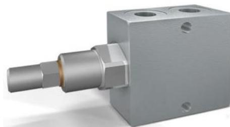
La funzione della valvola di massima è quella di assicurare che la pressione nel circuito **non** superi il valore impostato, inviando al serbatoio il fluido in eccesso mantenendo l'impianto in funzione. Si montano generalmente in derivazione fra un ramo in pressione e il serbatoio per proteggere gli elementi del circuito (pompe, motori, cilindri, valvole, ecc.) da picchi di pressione che potrebbero danneggiarli.
