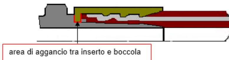
Procediamo alla pressatura del primo raccordo controllando il  $\varnothing$  esterno della boccola 30 mm.
