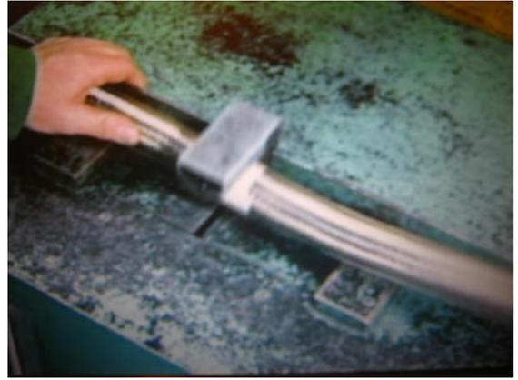
La foto sopra mostra come si procede al taglio di un tubo flessibile con guaina esterna in treccia di acciaio (es. tubi di teflon). Si nastra l'esterno del tubo per permettere un taglio netto e nello stesso tempo per contenere i fili d'acciaio della guaina esterna.
