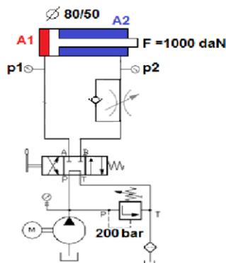
In fase di spinta nelle testate lato stelo si sviluppa una contro pressione  $p_2$  che è determinata dalle strozzature delle valvole di regolazione del flusso che farà intervenire la valvole di massima tarata a 200 bar.
