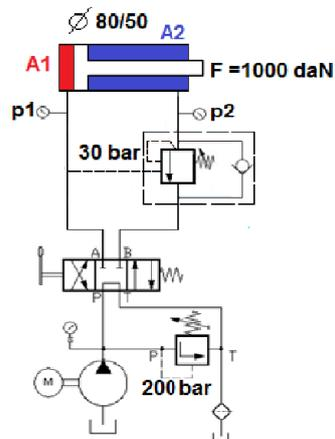
In fase di spinta è necessaria una pressione  $p_1 = 30$  bar per pilotare la valvola di bilanciamento.
