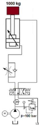
Un cilindro con  $D = 80 \text{ mm}$  e un'asta  $d_s = 45 \text{ mm}$ , deve spostare un carico di  $1000 \text{ Kg}$  sia in salita che in discesa ad una velocità max di  $3 \text{ m/s}$ . Il carico deve rallentare fino alle fine corsa per mezzo degli ammortizzatori che hanno una lunghezza di  $50 \text{ mm}$ .
