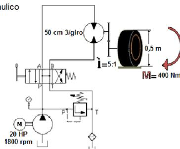
2) Se al mezzo necessitano 400 Nm per spostarsi, tenendo presente che il rapporto di riduzione è di 5:1, quindi il motore idraulico deve garantire  $400 : 5 = 80 \text{ Nm}$ .
