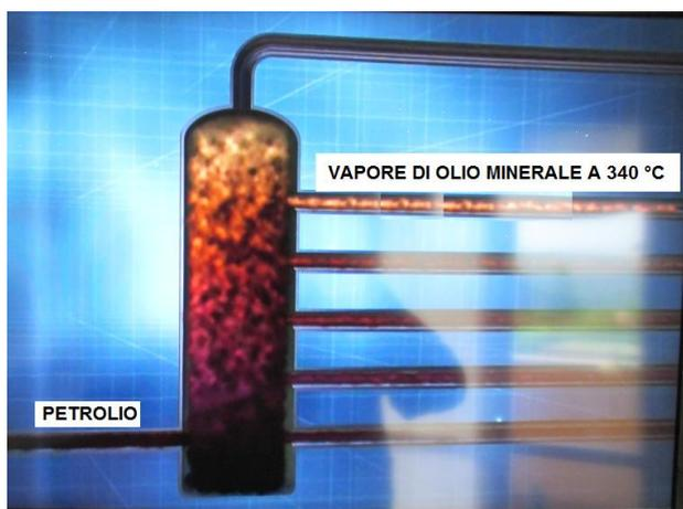
Ciascun elemento del greggio evapora a differenti temperature
