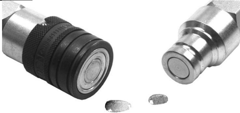
La costruzione secondo la norma ISO 16028, che prevede l'esecuzione con facce piane su entrambi gli innesti, offre il vantaggio di una facile pulizia, uno spillamento quasi nullo e una ridotta immissione d'aria nel circuito in fase di accoppiamento. La norma specifica le dimensioni dell'interfaccia per i requisiti d'intercambiabilità e prestazioni a una pressione da 25 MPa a 35 MPa.
