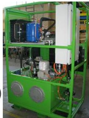
Il principio di funzionamento di un frigorifero si basa sul fenomeno dell'espansione Joule-Thomson di un fluido (freon): il fluido, nell'attraversare una strozzatura, si espande, assorbendo calore. Il dispositivo delegato a questo scopo è la cosiddetta valvola di
