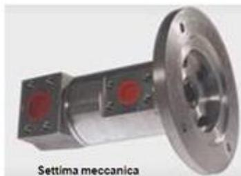
La **pompa a lobi** è formata da due meccanismi che hanno la forma di un biscotto o come da disegno sotto, di cui uno è collegato all'albero motore e trascina nella rotazione il meccanismo condotto. Durante la rotazione si genera una fase di aspirazione (verde) e una di mandata (rosso), con una zona di colore rosa che si trova in fase di mandata. La costruzione meccanica deve essere precisa e ciò
